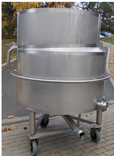
Obr. 5.15: Odměrná nádoba s přepadem 1000 L pro zkoušení cisteren na mléko
