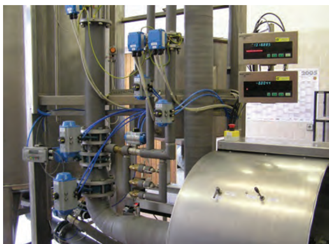
Obr. 3.9: Etalon Enbra – měřicí větve se sekundárními (pracovními) etalony
