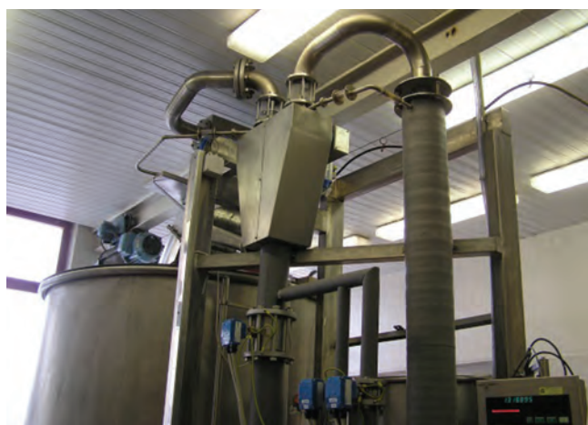
Obr. 3.8: Etalon Enbra – vázicí systém a přepínací klapka
