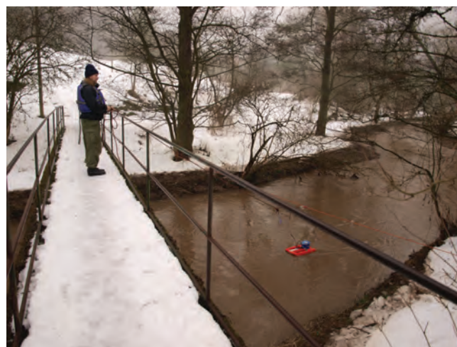
Obr. 4.6: Ultrazvukový snímač StreamPro ADCP se sondou připevněnou na plastový plovák držžený na laně
