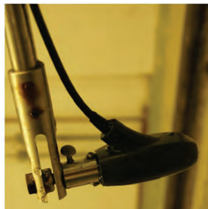
Obr. 4.5: Elektromagnetický snímač rychlosti proudění OTT MF Pro upevněný k tyči kalibračního vozíku
