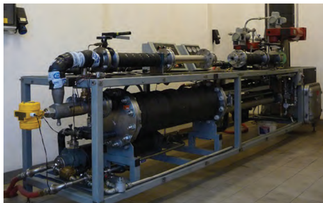
Obr. 5.6: Pístový etalonu průtoku kapalin Flow Dynamics
