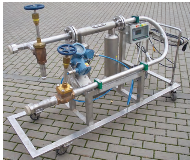
Obr. 5.16: Sestava s hmotnostním průtokoměrem pro zkoušení cisteren na kryogenní kapaliny
