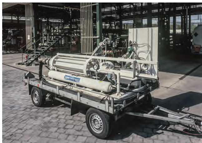
Obr. 5.8: Pístový etalon průtoku Brooks Compact Prover
