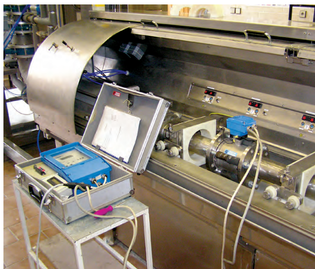
Obr. 3.10: Etalon Enbra – měřicí úsek a upínání měřidel
